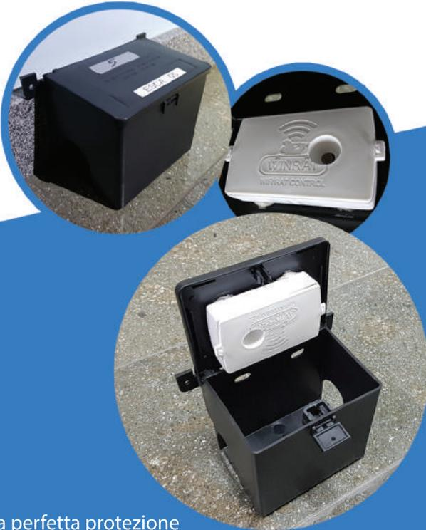
I dispositivi WINRAT inseriti all'interno dei bait box sono dotati di sensori che, al rilevamento di topi e ratti, inviano un segnale di ALERT alla centralina di controllo.
